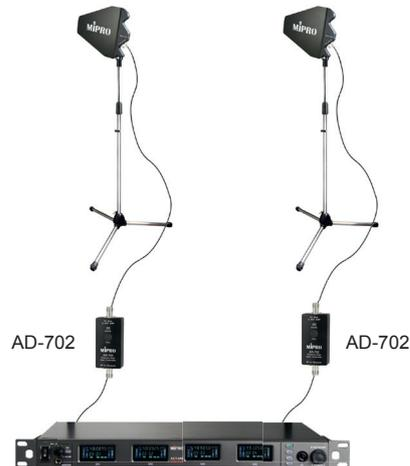
Der aktive Antennenadapter AD-702 ist mit einer intelligenten Elektronik ausgestattet, die die Signaldämpfung im Antennenkabel berechnet und dann die Signalverstärkung der aktiven Antenne optimal einstellt. Bei kleineren Anlagen mit nur einem Empfänger kann so die maximale Reichweite aller Kanäle garantiert werden.
