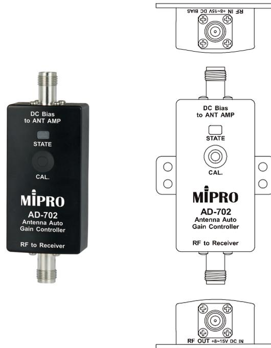
Der Antennensignaladapter AD-702 mit Auto-Gain Control erkennt automatisch die Dämpfung im Gesamtsystem die durch Signalleitungen entsteht und passt die optimale Verstärkung der im System befindlichen Antennen mit Auto-Gain Funktion bzw. den Signalverstärkern MPB-30 mit Auto-Gain Funktion automatisch an. Eine LED zeigt an, ob die optimale Systemverstärkung eingestellt werden kann.
