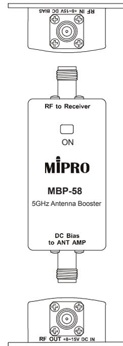
Der Antennensignalverstärker MPB-58 liefert eine konstante Verstärkung von 20 dB.
